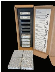
KIT DE PROFILS EN BÉTON ICRI
