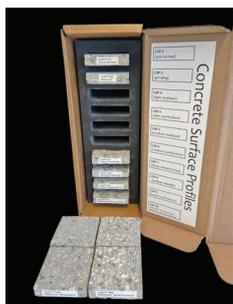
KIT DE PROFILS EN BÉTON ICRI
