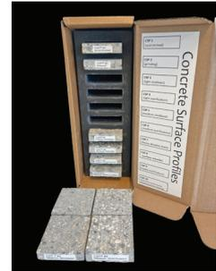
KIT DE PROFILS EN BÉTON ICRI
